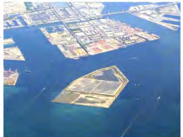
しゅんせつ土砂の埋め立てが進められる ポートアイランド（ホームベース型の島）
